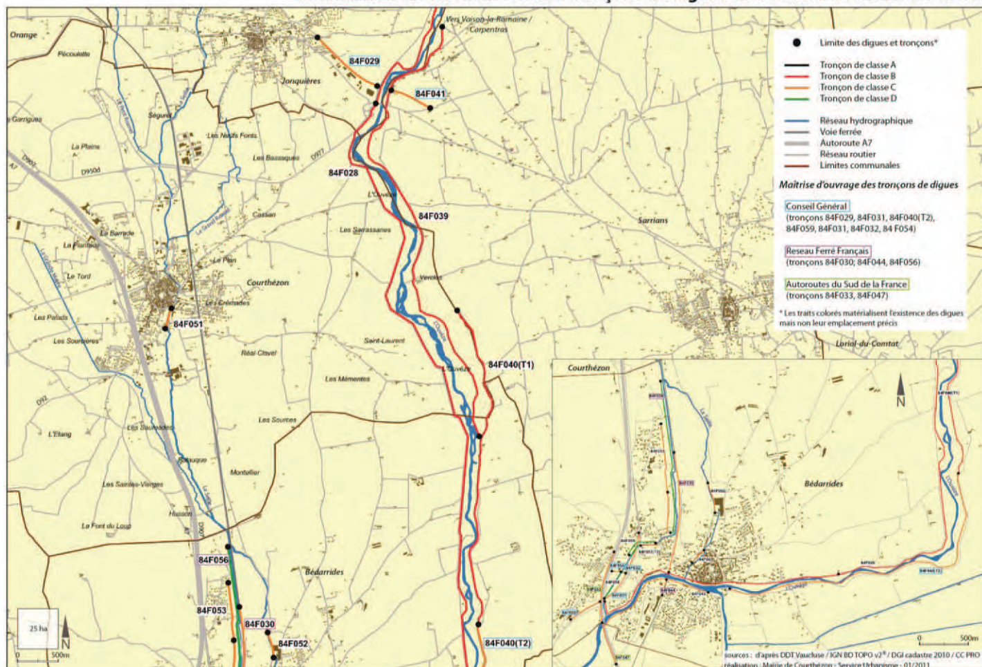
Localisation et classification des tronçons de digues de l'Ouvèze et de ses affluents
